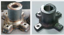
Figure 8 : Impression métallique brute, puis après reprise
