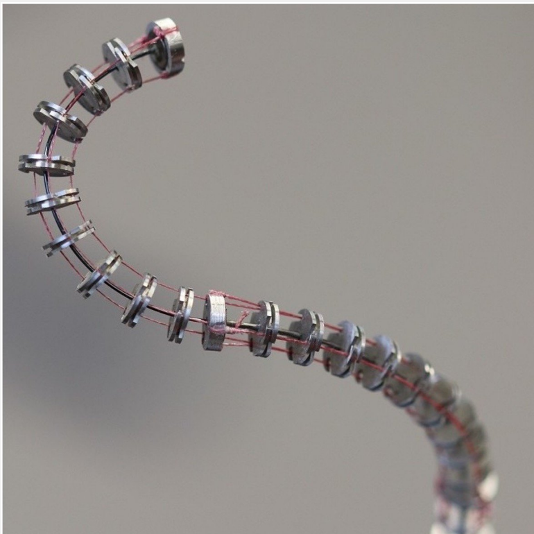
Figure 1 : Exemple de robot continu actionné par tendons Source : Continuum Robotics Lab, University of Toronto
